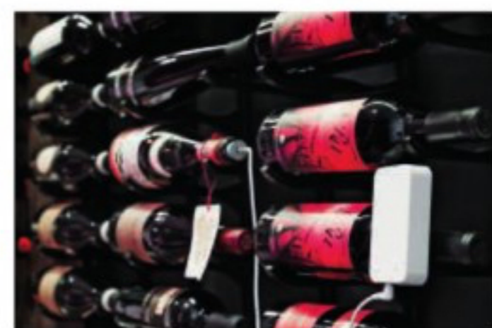
Sensorist-systemet giver mulighed for at kontrollere temperaturen og luftfugtigheden i vinkælderen. Svinger den for meget, modtager du en notifikation på en tilhørende app. Foto: Wineandbarrels.com
